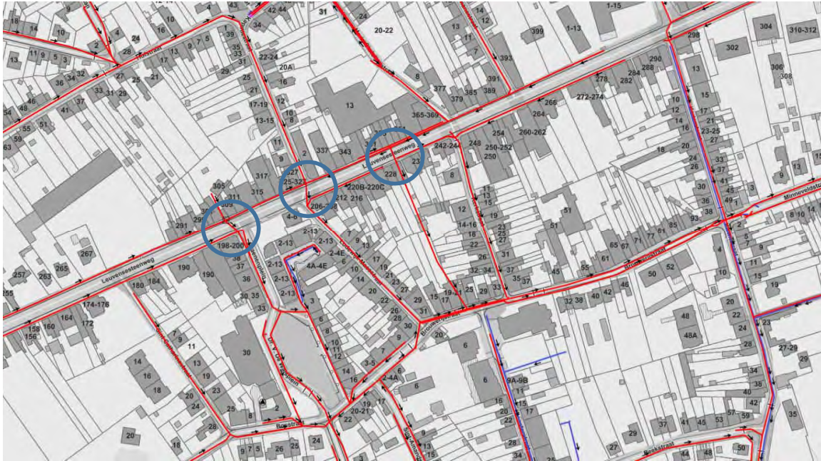
Figuur 7: Heel veel zonevreemd water steekt door naar het centrum van Kortenberg via 3 doorsteken aan de Leuvensesteenweg.
