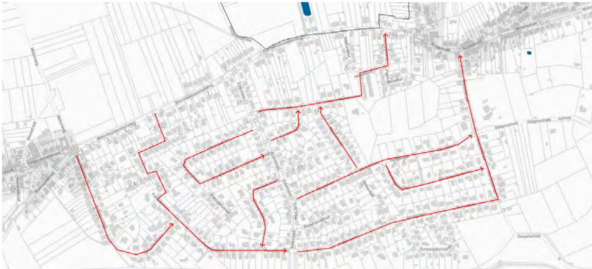
Figuur 12: Om zoveel mogelijk hemelwater vast te houden, kan éénrichtingsverkeer een oplossing zijn. De figuur geeft een mogelijk voorstel weer, maar dient nog met de veiligheidsdiensten afgestemd te worden.
