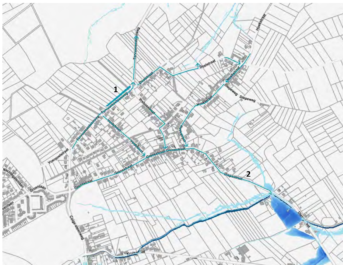
Figuur 24: Afstroomrichting en pluviale overstromingskaart (Bron: VMM) voor een T25
