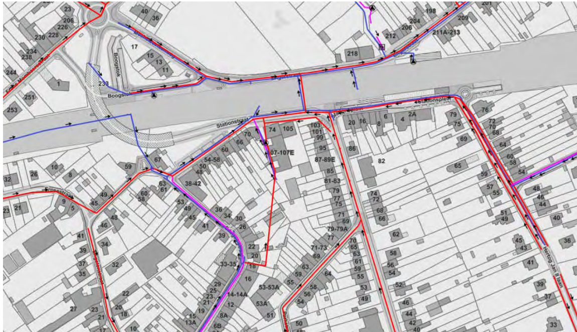
Figuur 11 illustreert de 2 doorsteken onder de spoorweg, 1 RWA en 1 gemengd. Door water van het gemengd systeem af te koppelen naar het RWA systeem wordt de doorvoercapaciteit onder de spoorweg gehalveerd!
