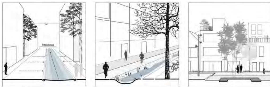
Straatprofielen met wateropvang (Delva Architecten: Dorp- of stadsstraat, bredere boulevard en groene hoven).
