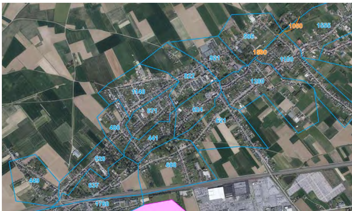
Figuur 20: De benodigde (blauwe) en beschikbare (oranje) buffering voor berging van een T20 in elke wijk
